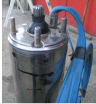
Resim 1 : Sargıları Yanmış(Patlamış) bir 4” dalgıç
