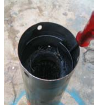
Resim 1 : Sargıları Yanmış(Patlamış) bir 4” dalgıç
