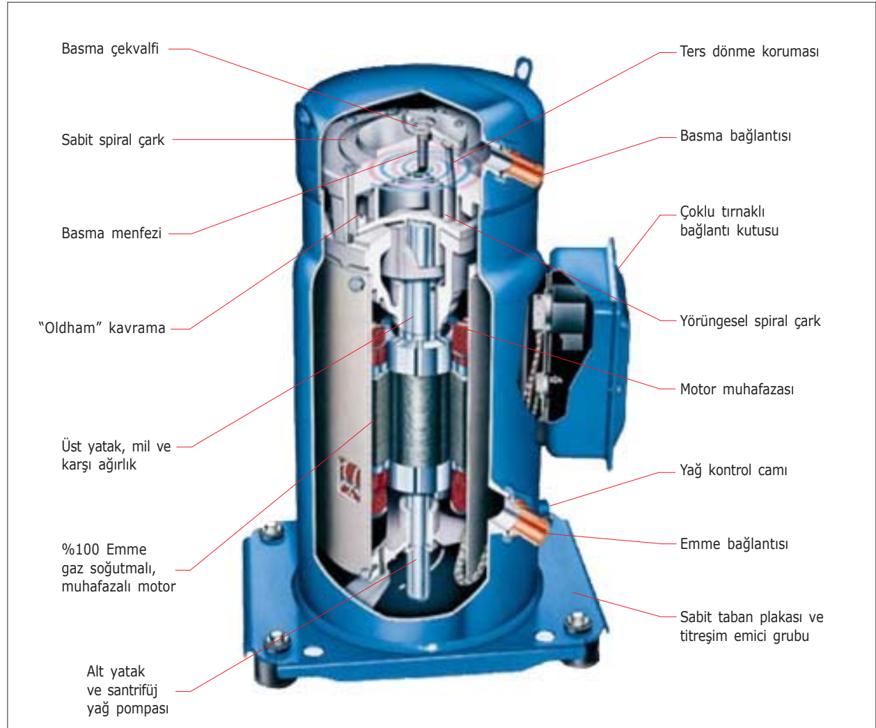
Şekil 8. Tam Hermetik Spiral Kompresör
